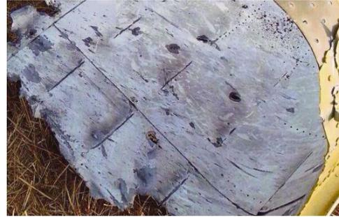
**Bild 2: Fragment der Verkleidung der Boeing 777**
