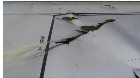
**Bild 4: Fragment des Flügels der Boeing 777**
